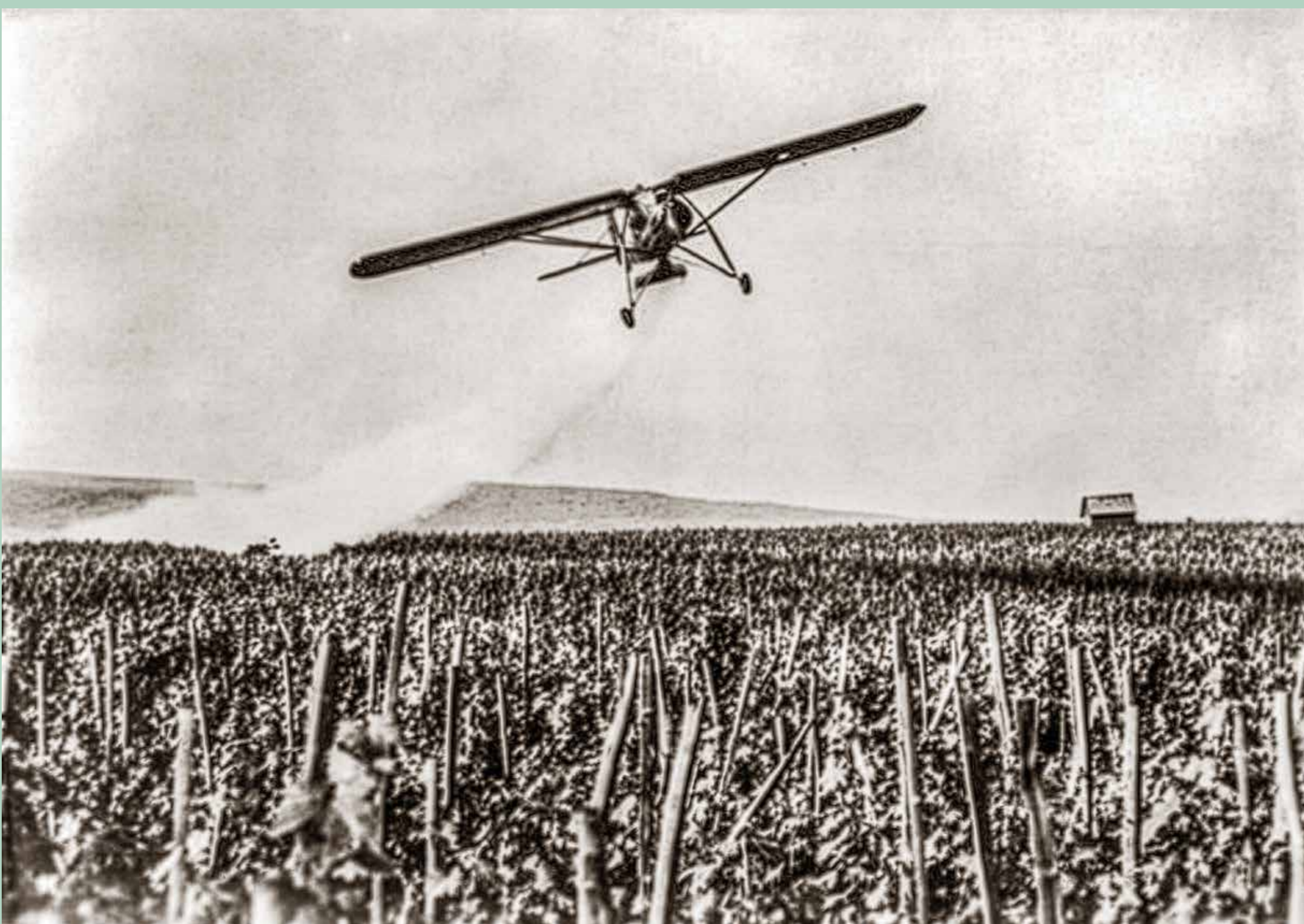
Erste Versuche, die Schädlinge mit Kontaktgiften aus der Luft zu bekämpfen, scheiterten am Widerstand der preußischen Forstverwaltung, die den Kauf von Kalk-Arsen nicht bewilligen wollte. Erst nach 1925 kam es zu ersten Sprühversuchen mit dem umgerüsteten Fokker Grulich Hochdecker in Biesenthal bei Eberswalde. In den 1930er Jahren waren es dann vor allem der Fieseler Storch 156 und die umgerüstete Junkers W 33, die im Agrarflug eingesetzt wurden.
